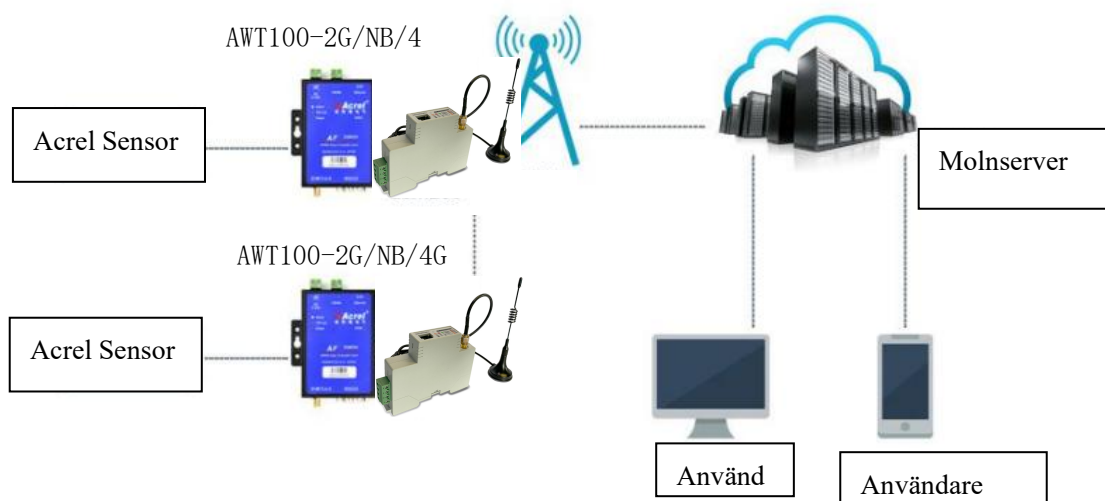
Bild 2 AWT100-2G/NB/4G Typisk tillämpning av terminal för trådlös kommunikation
